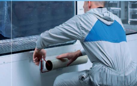
Dispenser mit Magneten unten an der Kabinenwand befestigen.
