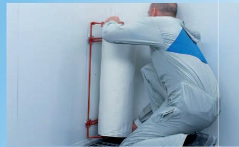
Dispenser mit Magneten unten an der Kabinenwand befestigen.
