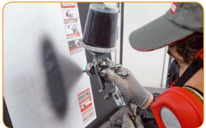
Bei Inbetriebnahme einer neuen Lackierpistole bzw. eines neuen Düsensatzes wird ein **Referenzspritzbild** erstellt. Dieses ist **Maßstab für nachfolgende Kontrollspritzbilder**, welche in regelmäßigen Zeitabständen, z. B. wöchentlich oder monatlich, **mit derselben Pistole** angefertigt werden.
